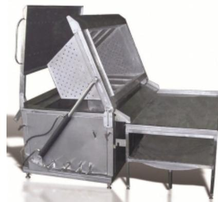
В стандартной комплектации варочный котел имеет одну секцию, крышку с термоизоляцией, перфорированную корзину автоматически выгружающую, посредством пневматического цилиндра, помещенный в неё для варки продукт.
